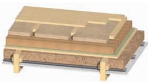
GUTEX Thermosafe-nf ® met profiellatten, geplaatst op een massieve plankenvloer
